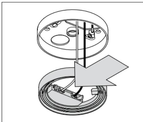
Netzseitige Phase und Nulleiter mit den Klemmen des Terminalrings verbinden.
