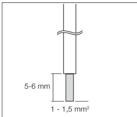
Enden der Netzleitungen 5-6 mm abisolieren.
