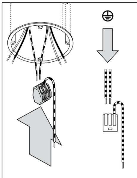
Netzseitige Erdungsleitungen mit der Klemme des Erdungskabels nach Schema verbinden.
