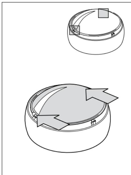
Linse/Farbfilter (optional) mit dem Rand in beide Federn einfügen und gegen die Federn drücken.
