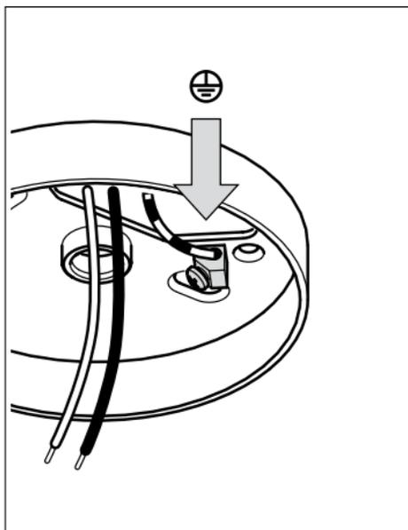
Netzseitige Erdungsleitung nach Schema mit der Klemme der Aufbaudose verbinden.
