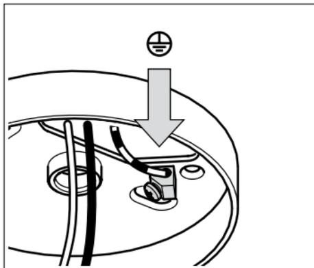
Netzseitige Erdungsleitung nach Schema
