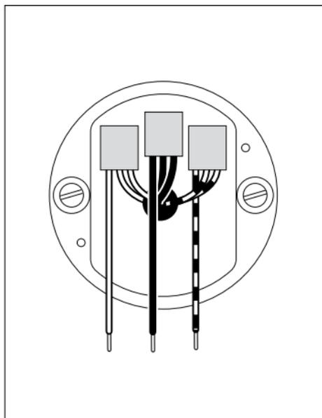
Kabel und Klemmen bündig in die Öffnung des Adapterrings einlegen.
