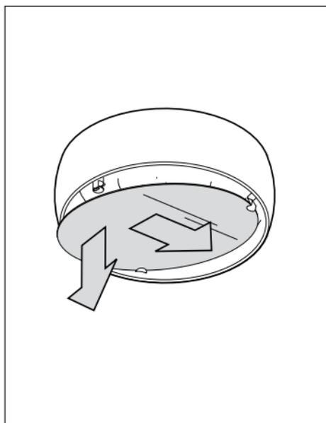
Glaseinsatz/Linse gegen die Federn drücken und aus der Nut des Auslösestifts entnehmen.
