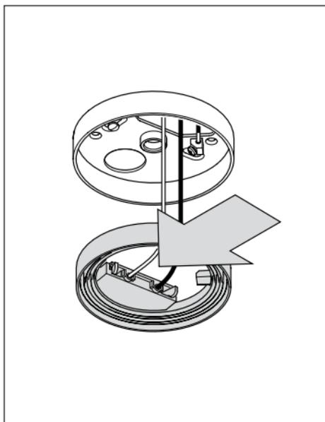
Netzseitige Phase und Nulleiter mit den Klemmen des Terminalrings verbinden.
