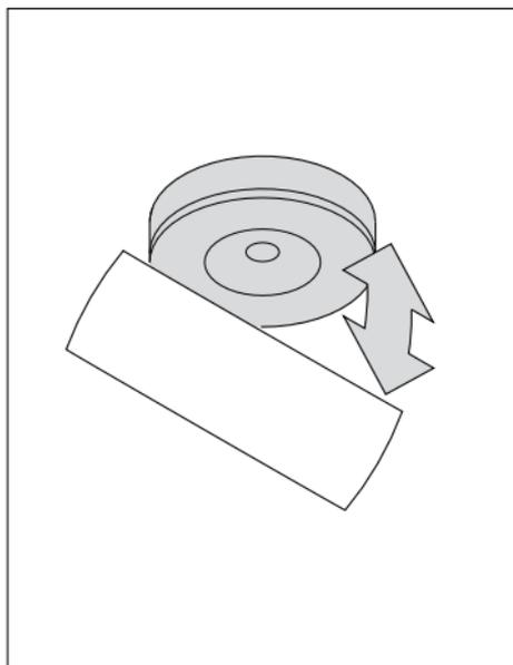
Grundplatte mit Aufbaudose auf der Rückseite des Strahlers aufklappen.
