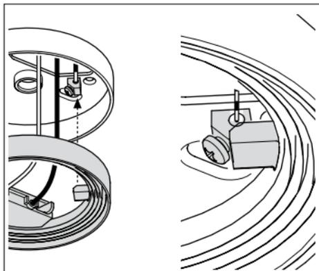
... dass die Erdungsklemme von der Isolierkappe abgedeckt wird.
