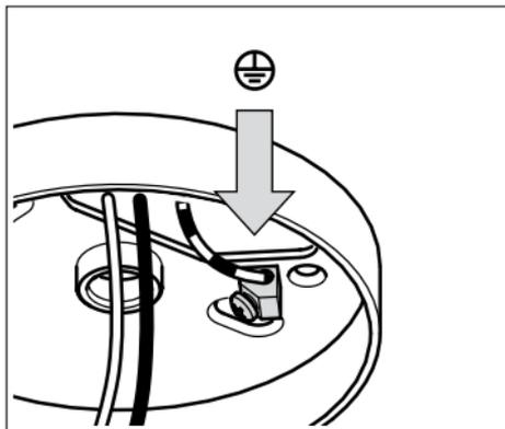
Netzseitige Erdungsleitung nach Schema
