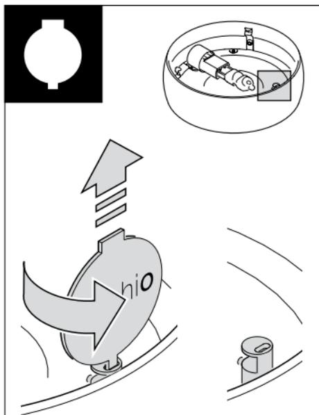
Occhio-Tool (beiliegend) mit dem schmalen Ende in die Nut des Auslösestifts einführen.
