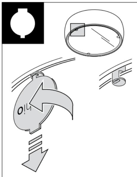
Occhio-Tool (beiliegend) mit dem schmalen Ende oder Schraubendreher in die Nut des Auslösestifts einführen.
