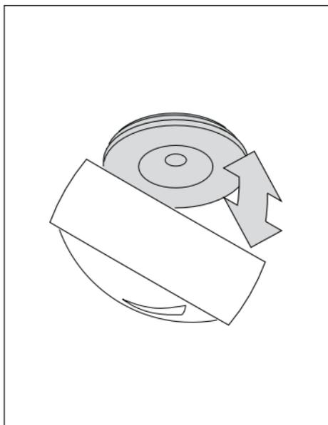
Befestigungsplatte auf der Rückseite des Strahlers aufklappen.
