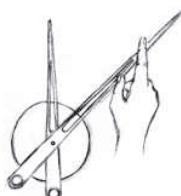
Girar cuidadosamente la aguja minutera en el sentido de las agujas del reloj hasta alcanzar las 12 en punto, ajustar la hora alineando las agujas horaria y minutera en vertical ,luego continuar girando la aguja minutera hasta alcanzar la hora deseada.
