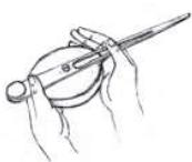
Introducir la aguja horaria presionando sobre el eje de la máquina hasta que haga tope.
